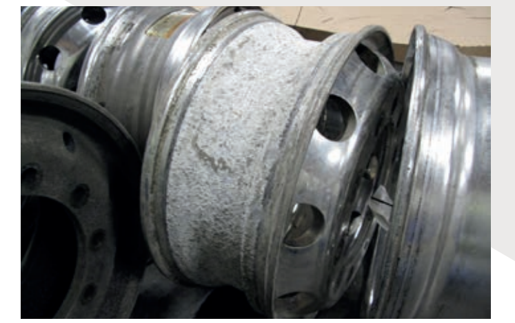
Corrosión causada por equilibradores o selladores líquidos de neumáticos
