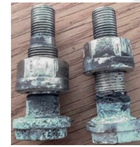
Válvulas con corrosión severa
