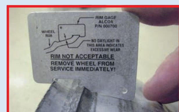
Desgaste NO aceptable del talón.
